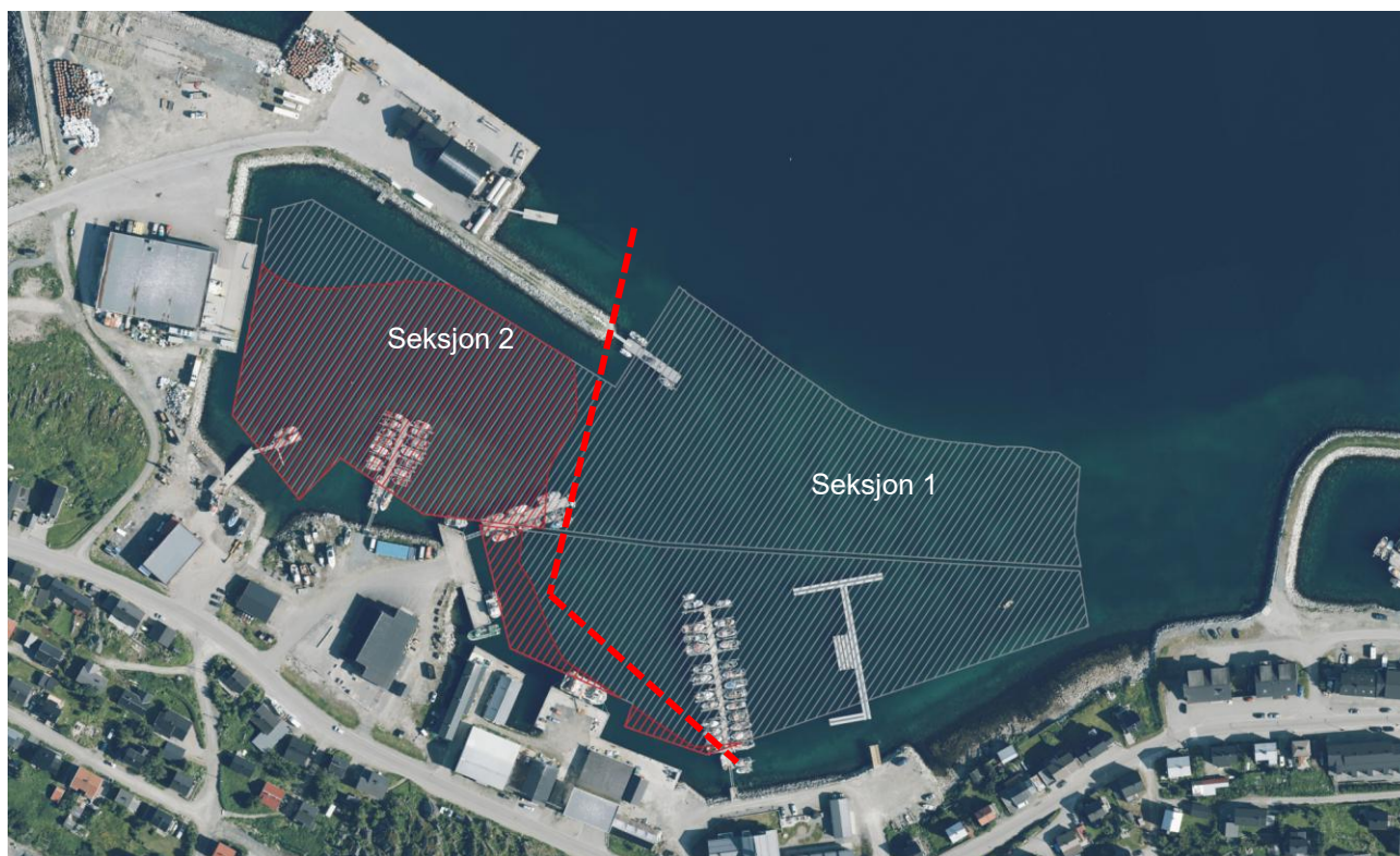
Figur 7 Eksisterende flytebrygger i Kjøllefjord havn skal flyttes i løpet av anleggsperioden. Utdypningsarealet er markert med grå skravur, og området som skal sprenges, er markert med rød skravur.
